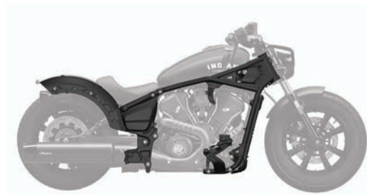
NUEVA ESTRUCTURA DE ACERO
