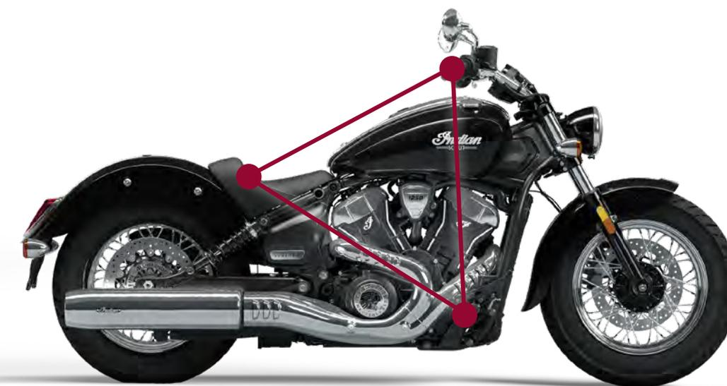
L'ergonomie de la motocyclette est axée autour du triangle formé entre l'emplacement du guidon, les commandes au pied et le siège afin de déterminer la position assise du conducteur. Assurez-vous d'avoir les bons accessoires pour maximiser votre posture, votre style de conduite et votre niveau de confort désiré.
