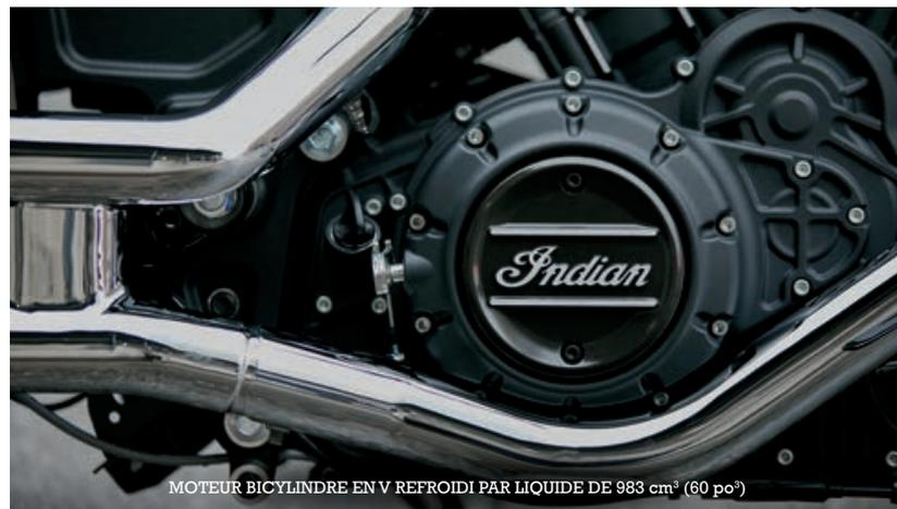
MOTEUR BICYLINDRE EN V REFROIDI PAR LIQUIDE DE 983 cm<sup>3</sup> (60 po<sup>3</sup>)
