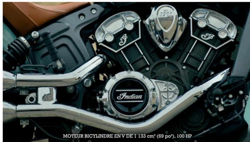
MOTEUR BICYLINDRE EN V DE 1 133 cm<sup>3</sup> (69 po<sup>3</sup>), 100 HP
