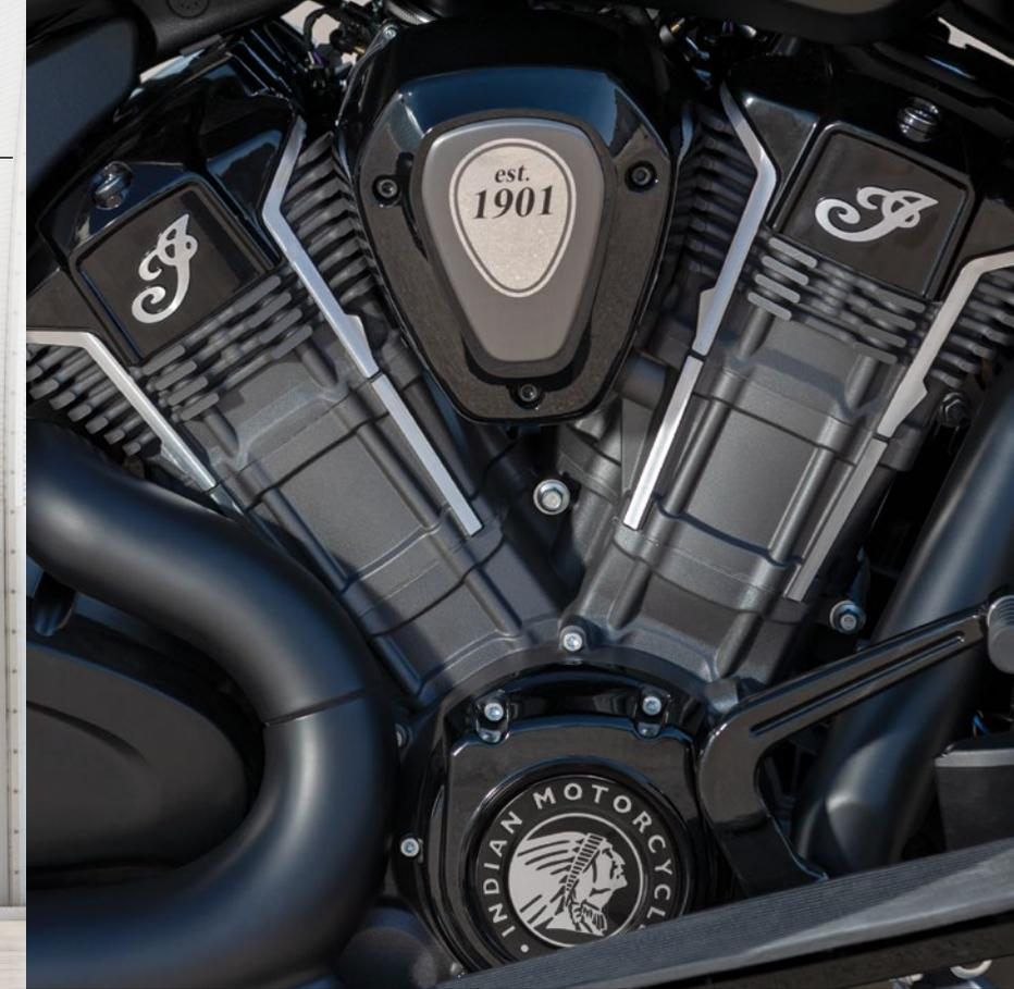
Notre tout nouveau bicylindre en V PowerPlus refroidi par liquide est le moteur le plus puissant de sa catégorie. Avec des arbres à cames en tête et quatre soupapes par cylindre délivrant une puissance de 122 hp et un couple de 174 N·m (128 lb·pi), il redéfinit la performance des Bagger's.
