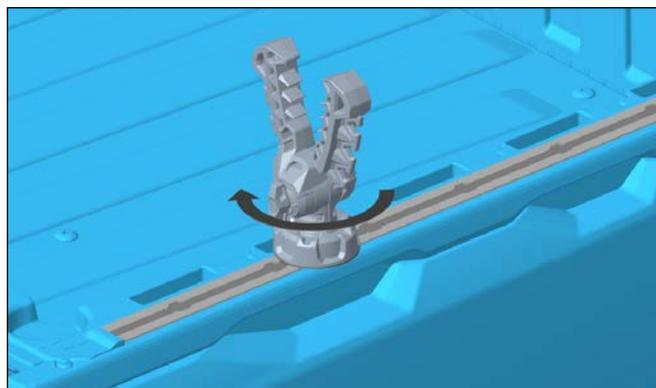
2. Insérez le boulon en T (2) dans le trou d'accès du rail Lock & Ride MAX et faites-le coulisser jusqu'à la position voulue. Veillez à ce que le profil de rail pratiqué sur le dessous du disque d'écartement se trouve dans l'ouverture du rail.
