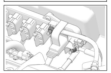
7. Install Pulse<sup>®</sup> bar connection (10) to Pulse<sup>®</sup> bar.
