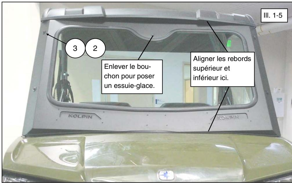
5. À partir de la surface avant du pare-brise, insérez des vis M6 (2) dans des rondelles M6 (3), puis dans chacun des quatre trous oblongs, comme le montre l'illustration. (Voir les illustrations 1-2 et 1-5.)
