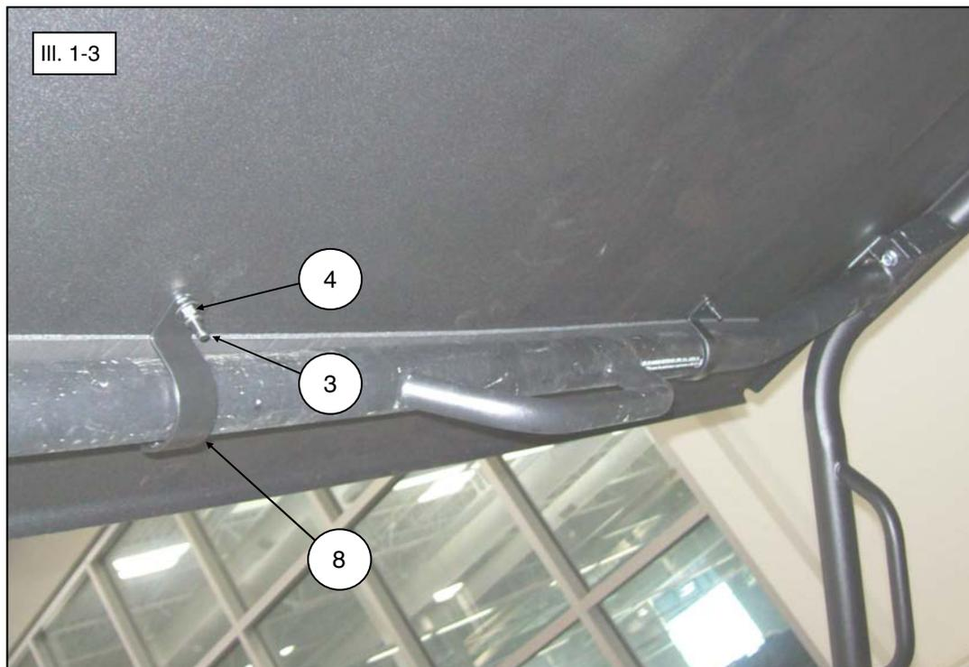
6. À partir de la surface inférieure du toit, posez sans les serrer les vis avant (3) avec deux écrous auto-freinés M6 (4) aux languettes des coins avant de l'armature de la cabine comme le montre l'illustration. (Voir l'illustration 1-4.) **Remarque : Ne serrez pas les fixations pour l'instant afin de permettre des ajustements plus tard.**
