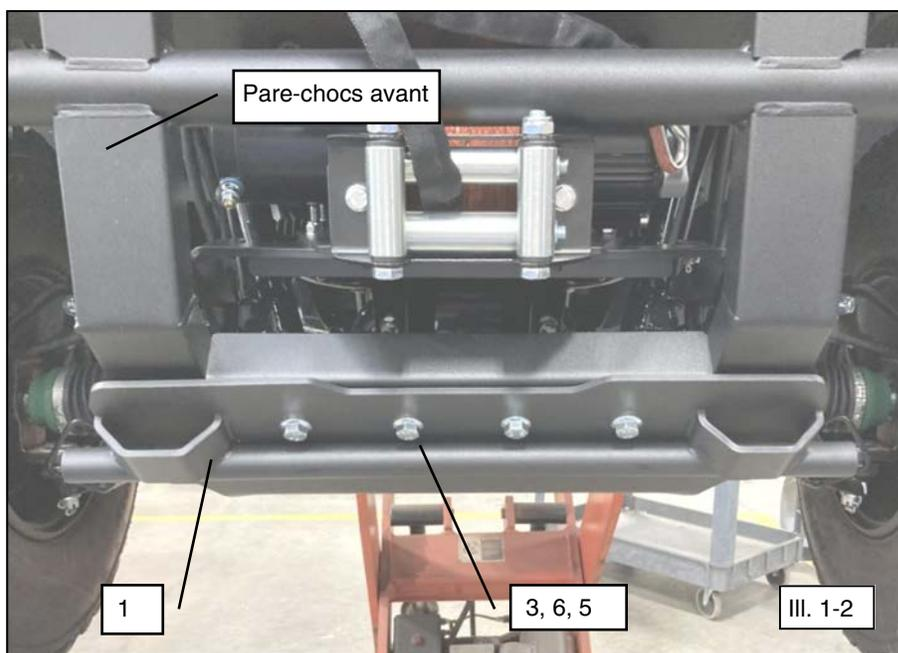
6. Pour les deux emplacements de montage arrière interne, il faut percer des trous dans la plaque de protection en plastique. Positionnez la plaque de montage (1) sur le châssis/la plaque de protection et marquez les deux emplacements pour les trous internes. Enlevez temporairement la plaque de montage (1) et servez-vous d'un foret de 1/2 po pour percer des trous dans la plaque de protection en plastique. (Voir les illustrations 1-3 et 1-4.)
