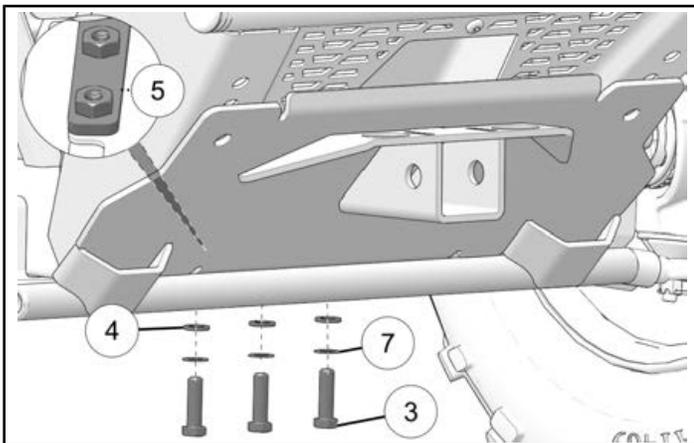
3. Installer deux vis supérieures ② et deux écrous ⑥. Installer l'écrou et le contre-écrou et serrer au couple spécifié.
