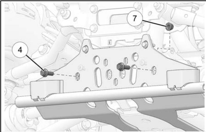
2. Installer la plaque d'écrou arrière ② derrière le carter d'engrenage avant. Installer d'abord les rondelles-freins ⑧, puis les rondelles plates ③, et installer les vis sans les serrer ⑥ à travers le support de montage.
