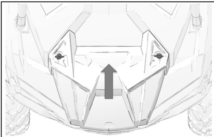
5. Tourner les fixations d'un quart de tour pour verrouiller le capot au véhicule.
