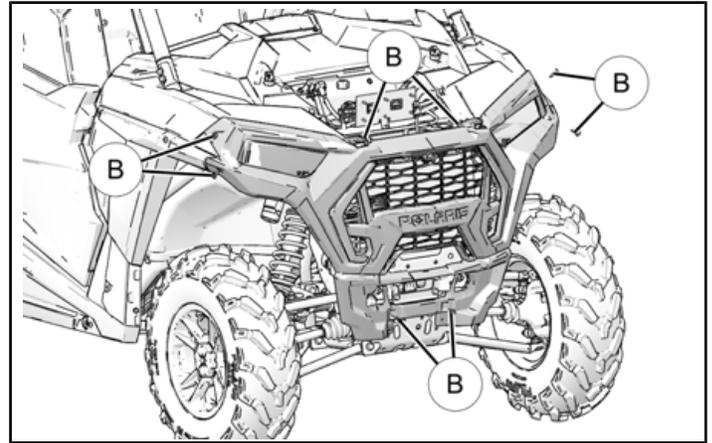
2. Installer les deux vis sans les serrer ⑤ sur le support de montage de chasse-neige.
