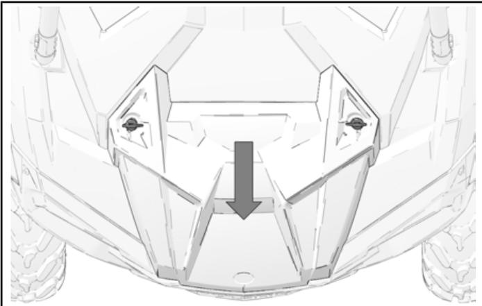
3. Retirer et conserver les deux vis (A). Retirer le couvercle du treuil.
