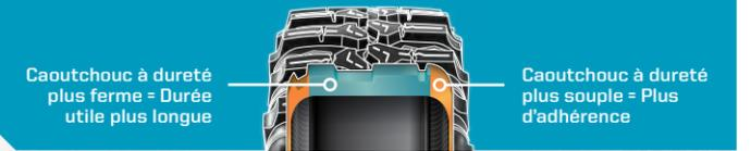
Caoutchouc à dureté plus ferme - Durée utile plus longue
