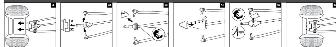
Retirez la roue et l'écrou à essieu.
