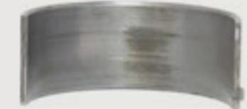
**PALIER DE BIELLE :** Les paliers de moteur lubrifié avec une huile avec une pellicule moins robuste et une viscosité plus faible peuvent expérimenter une usure prématurée ou même une défaillance du moteur.
