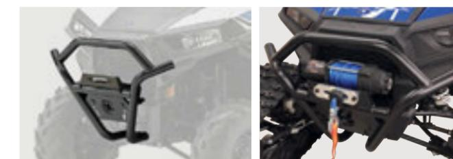
CONSTRUCTION EN TUBE D'ACIER D'UN DIAMÈTRE DE 1 3/4 po
