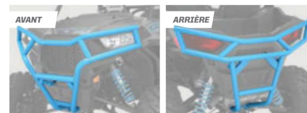
CONSTRUCTION EN TUBE D'ACIER D'UN DIAMÈTRE DE 1 1/2 po
