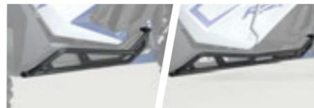
CONSTRUCTION EN ACIER TUBULAIRE DE 1 3/4 po DÉPASSE DU VÉHICULE POUR UNE PROTECTION MAXIMALE SUR LES TERRAINS DIFFICILES
