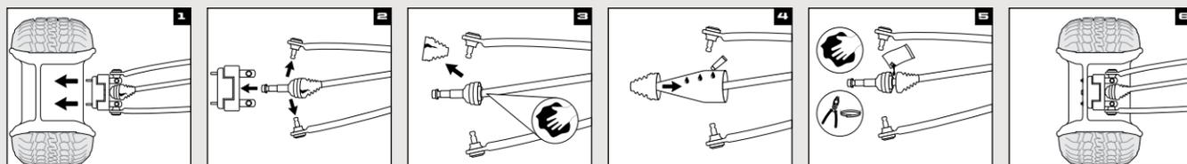
1. Retirez la roue et l'écrou à essieu.
