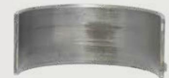
**PALIER DE BIELLE :** Les paliers de moteur lubrifié avec une huile avec une pellicule moins robuste et une viscosité plus faible peuvent expérimenter une usure prématurée ou même une défaillance du moteur.
