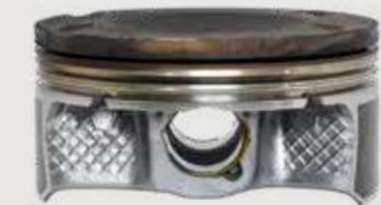
**SEGMENTS DE PISTON ET CORDONS DE SEGMENT :** Ces pièces soumises à une pression extrême requièrent une pellicule de lubrifiant très robuste. Une mauvaise performance oxydative peut provoquer une accumulation de carbone et de vernis et causer une étanchéité de segment insuffisante et une dilution du carburant dans l'huile. Cela peut causer une perte de puissance et une usure accélérée du moteur.
