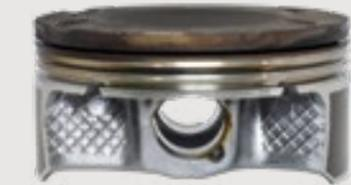
**SEGMENTS DE PISTON ET CORDONS DE SEGMENT :** Ces pièces soumises à une pression extrême requièrent une pellicule de lubrifiant très robuste. Une mauvaise performance oxydative peut provoquer une accumulation de carbone et de vernis et causer une étanchéité de segment insuffisante et une dilution du carburant dans l'huile. Cela peut causer une perte de puissance et une usure accélérée du moteur.
