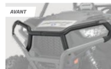
CONSTRUCTION EN TUBE D'ACIER D'UN DIAMÈTRE DE 1 3/4 po
