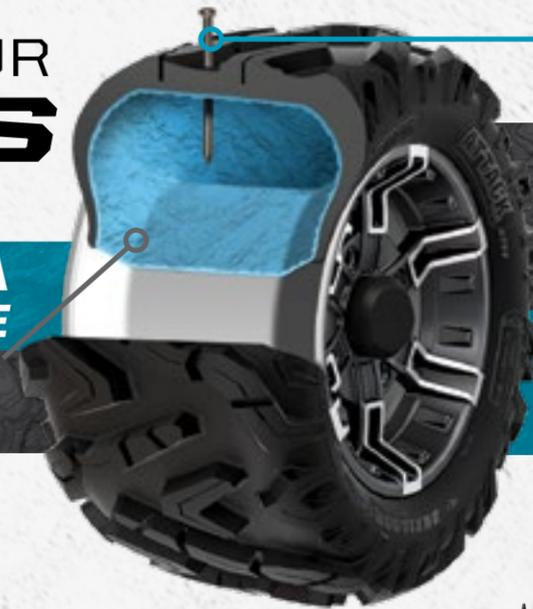
Lorsqu'une fuite se produit, le scellant pour pneus s'écoule rapidement en dehors du pneu pour créer un colmatage solide et permanent.
