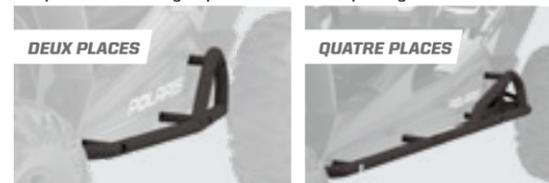
CONSTRUCTION EN TUBE D'ACIER D'UN DIAMÈTRE DE 1 3/4 po
