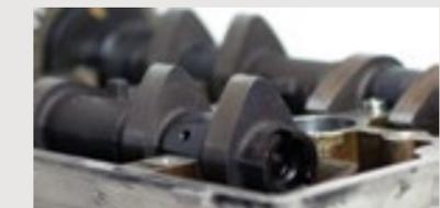
**ARBRE À CAMES :** Des arbres à cames en tête à action directe sont utilisés sur plusieurs moteurs Polaris. Dans ce cas, l'arbre à cames pousse directement sur la soupape créant des pressions de contact très élevées comparativement aux autres configurations d'arbre à cames. Ces forces exercées sont tellement élevées qu'une huile de qualité inférieure peut se dégrader et entraîner une usure accrue et des dommages potentiels au moteur.
