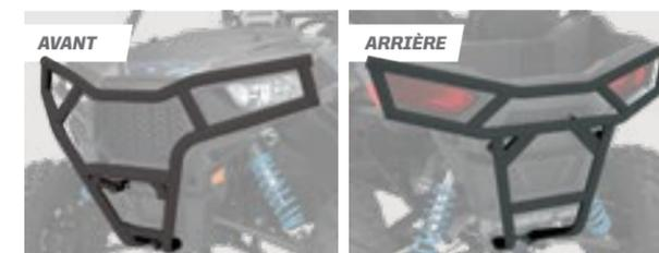
CONSTRUCTION EN TUBE D'ACIER D'UN DIAMÈTRE DE 1 1/2 po
