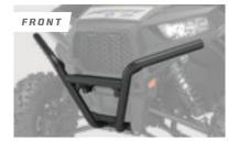
**1¾" DIAMETER** STEEL TUBE CONSTRUCTION Ο
