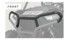
1¾" DIAMETER Ο STEEL TUBE CONSTRUCTION
