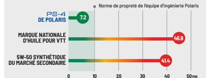
ASTM D6335. Dans des essais de tiers avec 9 produits concurrents, l'huile PS-4 de Polaris produisait moins de la moitié des dépôts par rapport au prochain produit s'y rapprochant. Aucun autre produit testé n'a atteint les normes de propreté de l'équipe d'ingénierie Polaris. L'essai mesure la masse de dépôts en mg à des températures élevées, cycles d'essai sous contrainte élevée. Des dépôts supérieurs affecteront la puissance motrice et la performance.
