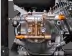
Pompe à came AAA Simpson avec soupape de décharge thermique
