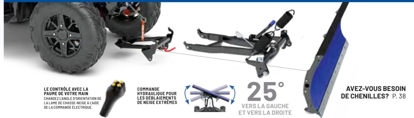
LE CONTRÔLE AVEC LA PAUME DE VOTRE MAIN CHANGE L'ANGLE D'ORIENTATION DE LA LAME DE CHASSE-NEIGE À L'AIDE DE LA COMMANDE ÉLECTRIQUE.
