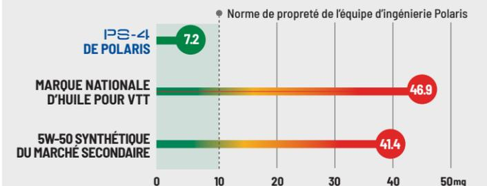
ASTM D6335. Dans des essais de tiers avec 9 produits concurrents, l'huile PS-4 de Polaris produisait moins de la moitié des dépôts par rapport au prochain produit s'y rapprochant. Aucun autre produit testé n'a atteint les normes de propreté de dépôts de l'équipe d'ingénierie Polaris. L'essai mesure la masse de dépôts en mg à des températures élevées, cycles d'essai sous contrainte élevée. Des dépôts supérieurs affecteront la puissance motrice et la performance.
