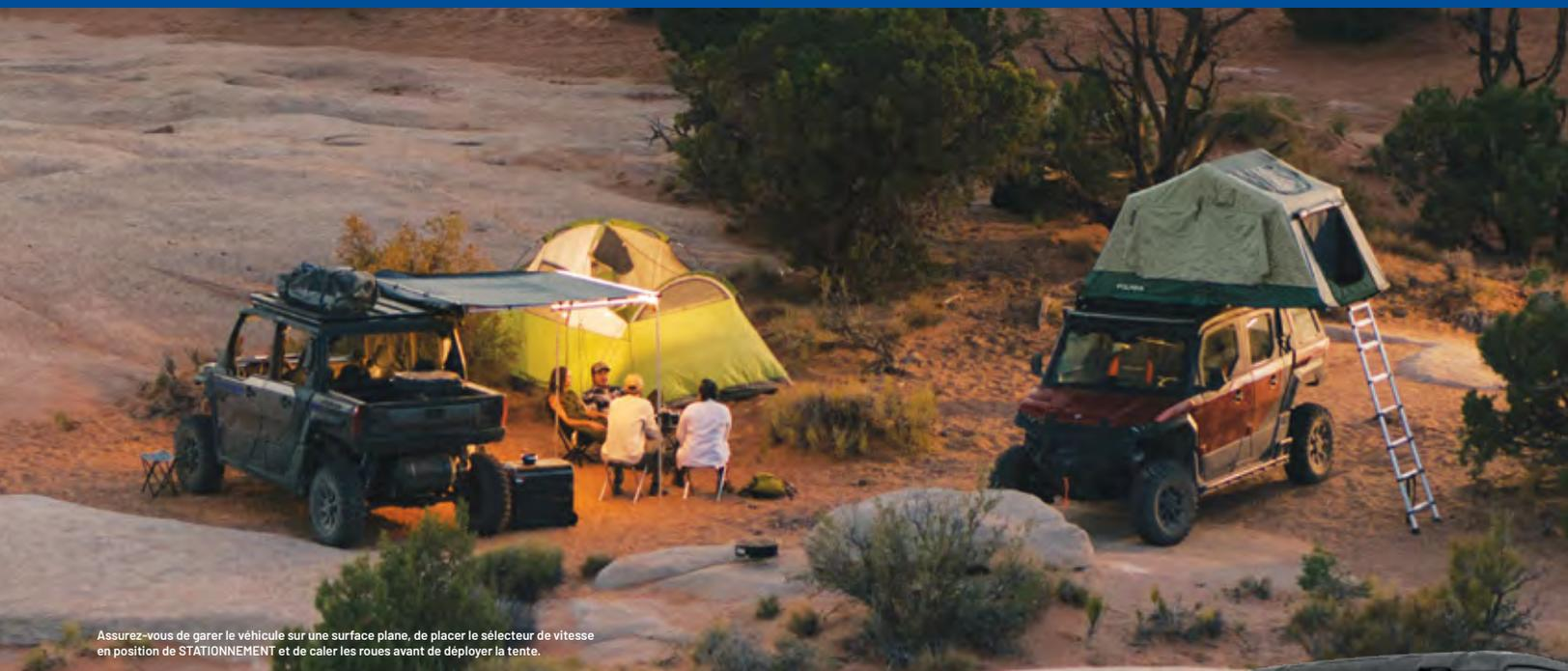
Assurez-vous de garer le véhicule sur une surface plane, de placer le sélecteur de vitesse en position de STATIONNEMENT et de caler les roues avant de déployer la tente.
