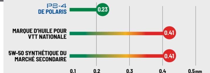
ASTM D472. Dans des essais de tiers avec 9 produits concurrents, l'huile de Polaris offrait 40 % ou plus de protection contre l'usure par rapport à tous les autres produits testés. Les chiffres représentent l'usure mesurée en mm. L'essai mesure l'usure aux points de contact; la longueur et la largeur de la cicatrice d'usure sont mesurées en mm. Des chiffres inférieurs signifient une meilleure protection contre l'usure et réduction de la friction.
