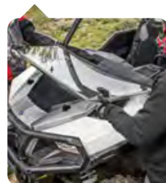
Options de pare-brise entièrement étanche ou rabattable. La moitié supérieure se détache, laissant la partie inférieure pour une protection avec aération maximale.
