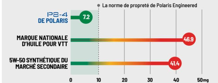
ASTM D6335. Dans des essais de tiers avec 9 produits concurrents, l'huile PS-4 de Polaris produisait moins de la moitié des dépôts par rapport au prochain produit s'y rapprochant. Aucun autre produit testé n'a atteint les normes de propreté de dépôts de Polaris Engineered. L'essai mesure la masse de dépôts en mg pendant des cycles d'essai à température et contrainte élevées. Des dépôts supérieurs affecteront la puissance motrice et la performance.
