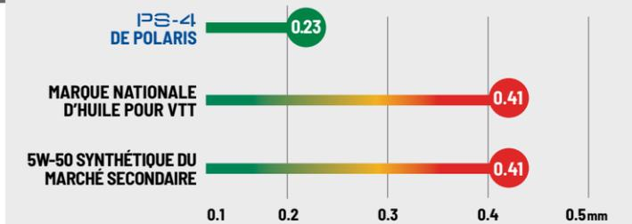
ASTM D4172. Dans des essais de tiers avec 9 produits concurrents, l'huile de Polaris offrait 40 % ou plus de protection contre l'usure par rapport à tous les autres produits testés. Les chiffres représentent l'usure mesurée en mm. L'essai mesure l'usure aux points de contact; la longueur et la largeur de la cicatrice d'usure sont mesurées (en mm). Des chiffres inférieurs signifient une meilleure protection contre l'usure et réduction de la friction.
