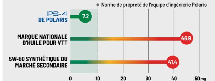
ASTM D6335. Dans des essais de tiers avec 9 produits concurrents, l'huile PS-4 de Polaris produisait moins de la moitié des dépôts par rapport au prochain produit s'y approchant. Aucun autre produit testé n'a atteint les normes de propreté de dépôts de l'équipe d'ingénierie Polaris. L'essai mesure la masse de dépôts en mg pendant des cycles d'essai à température et contrainte élevées. Des dépôts supérieurs affecteront la puissance motrice et la performance.
