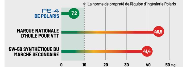
ASTM D6335. Dans des essais de tiers avec 9 produits concurrents, l'huile PS-4 de Polaris produisait moins de la moitié des dépôts par rapport au prochain produit s'y rapprochant. Aucun autre produit testé n'a atteint les normes de propreté de dépôts de l'équipe d'ingénierie Polaris. L'essai mesure la masse de dépôts en mg pendant des cycles d'essai à température et contrainte élevées. Des dépôts supérieurs affecteront la puissance motrice et la performance.
