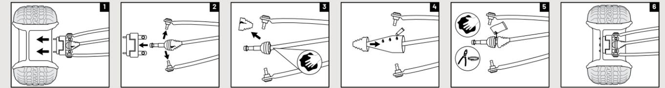
Retirez la roue et l'écrou à essieu.
