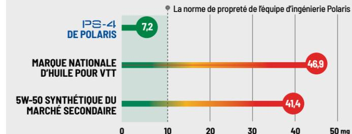
ASTM D6335. Dans des essais de tiers avec 9 produits concurrents, l'huile PS-4 de Polaris produisait moins de la moitié des dépôts par rapport au prochain produit s'y rapprochant. Aucun autre produit testé n'a atteint les normes de propreté de dépôts de l'équipe d'ingénierie Polaris. L'essai mesure la masse de dépôts en mg pendant des cycles d'essai à température et contrainte élevées. Des dépôts supérieurs affecteront la puissance motrice et la performance.
