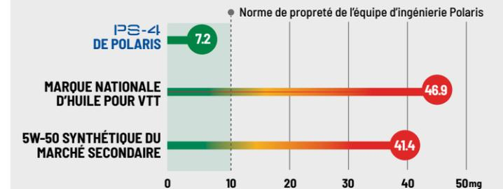
ASTM D6335. Dans des essais de tiers avec 9 produits concurrents, l'huile PS-4 de Polaris produisait moins de la moitié des dépôts par rapport au prochain produit s'y rapprochant. Aucun autre produit testé n'a atteint les normes de propreté de l'équipe d'ingénierie Polaris. L'essai mesure la masse de dépôts en mg pendant des cycles d'essai à température et contrainte élevées. Des dépôts supérieurs affecteront la puissance motrice et la performance.
