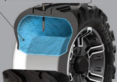
Le scellant crée un colmatage solide et permanent et maintient la pression du pneu de telle sorte que vous pouvez continuer à rouler.
