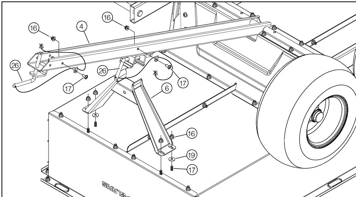
8. Positionner et fixer les renforts arrière droit (#10) et gauche (#11) à la boîte en utilisant les trous de pivot du panneau arrière comme référence à l'aide de (12) vis mécaniques à épaulement prises Allen M8-1.25 X 20mm (#17) et de (12) écrous autobloquants à épaulement M8-1.25 (#16) (ne pas serrer pour le moment).
