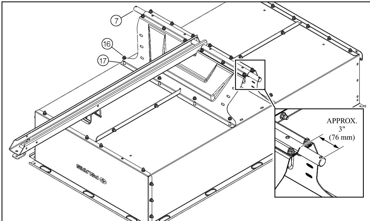
4. Appliquer de la graisse sur l'essieu (#7). Insérer une cale d'espacement 46mm X 26mm X 1.5mm (#21) et le bras de suspension assemblé (#8) sur l'essieu (#7). *Note : Il est suggéré de relubrifier occasionnellement.*
