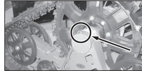
Figure 25 - Localisation du graissage de l'axe de la chenille avant
