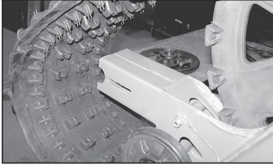
Figure 44 - Glissière d'ajustement retirée
