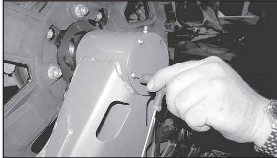
Figure 34 - Retrait du couvert de roulement
