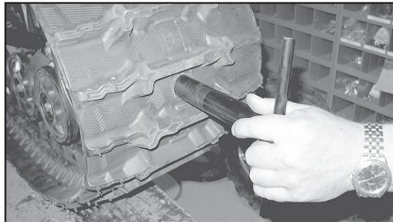
Figure 30 - Retrait du boulon d'ajustement
