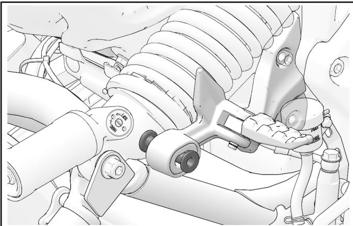
2. Far scorrere la fascetta del tubo di scarico ⑨ sulla base del tubo e collocare quest'ultimo sul risonatore dello scarico. Allineare il gruppo di scarico dietro il poggiatesta del passeggero e installare il dispositivo di fissaggio ⑫ dell'isolante del silenziatore attraverso l'isolante stesso e il supporto del poggiatesta del passeggero.
