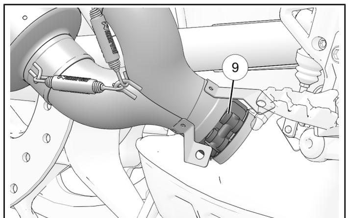
4. Rimuovere il dispositivo di fissaggio ⑫ dell'isolante del silenziatore, precedentemente utilizzato in questa sezione, e reinstallarlo con una rondella ⑬, un distanziale messo da parte precedentemente ④ e un dado ⑭.
