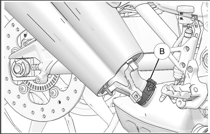
3. Rimuovere il dispositivo di fissaggio ③ dell'isolante del silenziatore e il distanziale ④.
