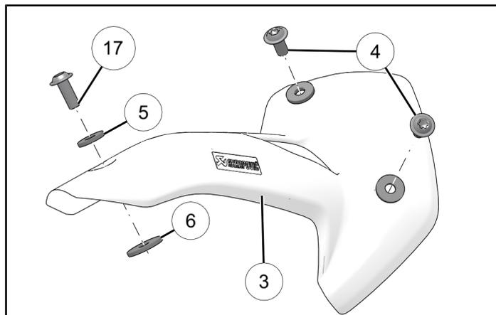
9. Installare lo scudo termico ③ sul tubo di scarico. Verificare che i distanziali siano allineati ai dadi a fermaglio al di sotto dello scudo termico.
