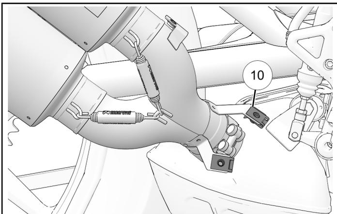
7. Verificare che nel punto di fissaggio inferiore vengano usati due dispositivi di fissaggio ④ per scudi termici (lunghi). L'utilizzo di dispositivi di fissaggio ④ (lunghi) invece di ⑰ (corti) per gli attacchi superiori potrebbe causare la foratura del tubo di scarico.
