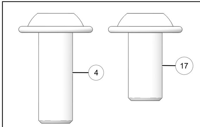
8. Infilare i dispositivi di fissaggio ④ e ⑰ dello scudo termico nelle rondelle ⑤, nello scudo termico ③ e nei tre distanziali ⑥.
