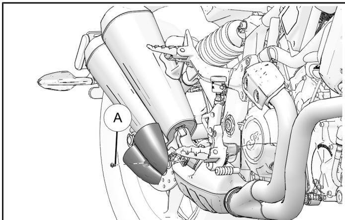
2. Rimuovere la fascetta dello scarico ② che fissa il silenziatore sul risonatore dello scarico.
