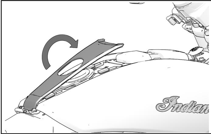
8. Vuelva a colocar el bisel del depósito con los cuatro fijadores del bisel guardados (A) y los cuatro limitadores de compresión guardados (B).
