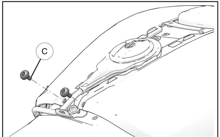
4. Tire hacia afuera de la parte inferior de cada cubierta del depósito para separar los remaches de plástico en las dos posiciones marcadas.
