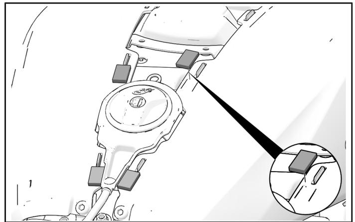
7. Coloque la lengüeta de la consola central dentro de la pieza de soporte inferior y dele la vuelta hacia la posición instalada. Presione firmemente en los puntos de las almohadillas adhesivas para asegurarse de que cada almohadilla se adhiera a la cubierta del depósito.
