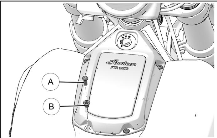
2. Incline la consola central hacia arriba para desmontarla de la cubierta del depósito.
