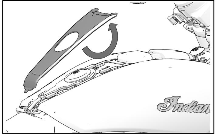
3. Extraiga y guarde los dos fijadores de la cubierta del depósito (C) del extremo trasero de las cubiertas del depósito.
