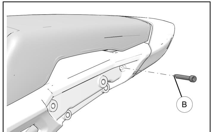
3. Deslice el respaldo del asiento hacia atrás y arriba para asegurarse de que el asiento sale de los soportes para desmontarlo de la motocicleta.
