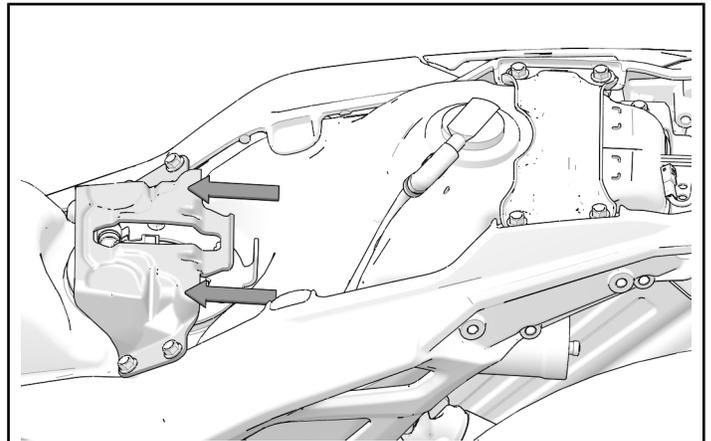
3. Deslice el asiento hacia el interior de la pieza de soporte del asiento y de la pieza de soporte de montaje delantera.
