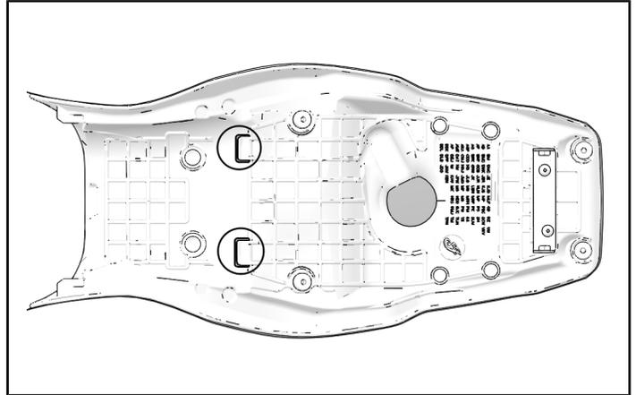
2. Las lengüetas identificadas en el paso 1 de esta sección se deslizarán debajo de la pieza de soporte del asiento.
