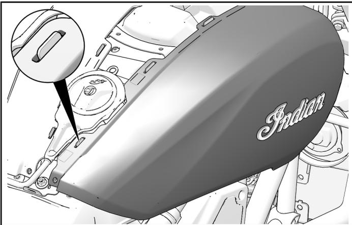
4. Empuje firmemente la cubierta inferior del depósito hacia el interior de las arandelas de goma. Asegúrese de que los remaches de ambas cubiertas del depósito están firmes y que la arandela de goma no se ha forzado a través de la pieza de soporte.
