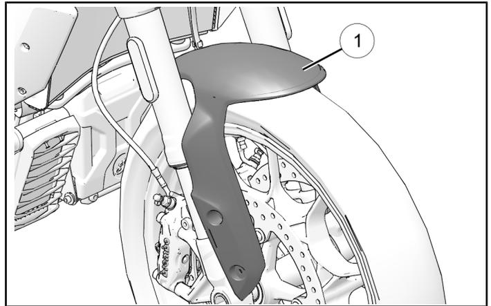
2. Sin apretar, instale el guardabarros ① con los cuatro fijadores del guardabarros ② y las cuatro arandelas ③, antes de apretar los elementos de sujeción.
