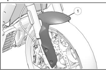
2. Installer le garde-boue ① sans serrer avec quatre fixations de garde-boue ② et quatre rondelles ③, avant de serrer la quincaillerie.
