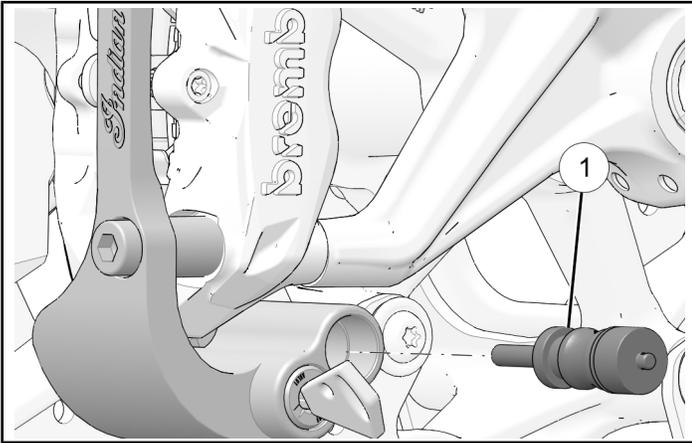
5. Muovere la motocicletta in avanti o indietro finché il perno di bloccaggio non impegna il rotore.
