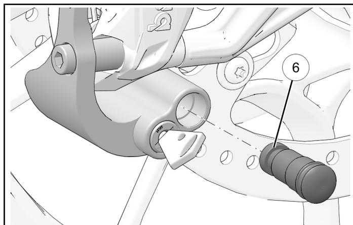
4. Installare il perno di bloccaggio a molla ① e girare la chiave nella posizione di BLOCCO.
