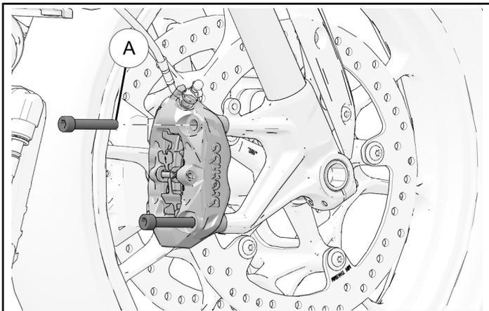
2. Allineare alla pinza del freno il bloccadisco ② e i due distanziali ③. Infilare i due dispositivi di fissaggio del bloccadisco ④ nel bloccadisco e nei distanziali.
