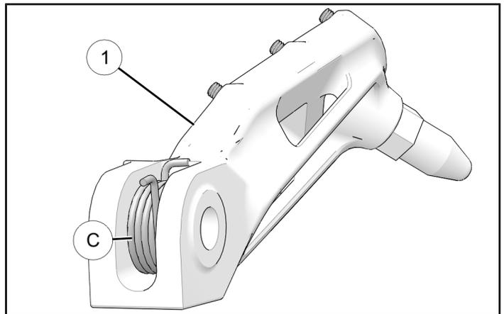
3. Fußraсте (1) in die Fußrastenbefestigung einsetzen und vorher aufgehobenen Bolzen (B) durch die Halterung und die Fußraсте (1) führen. Sicherstellen, dass das Federende (C) in den Fußrastenaufnehmer eingepasst ist.
