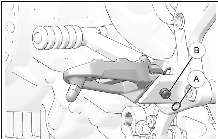
2. Einen Bolzen (B) und eine Fußrastenfeder (C) entfernen und beiseite legen, um Fußraсте zu entfernen.
