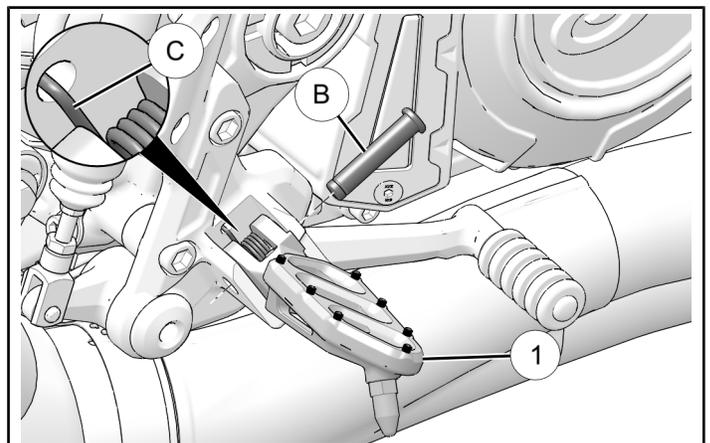
4. Den Bolzen (B) mit dem Sicherungsring (4) befestigen.
