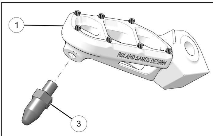
2. Vorher beiseitegelegte Fußrastenfeder (C) in Fußrastenaufnehmer einsetzen (1). Sicherstellen, dass die Enden der beiden Federn wie abgebildet ausgerichtet sind.
