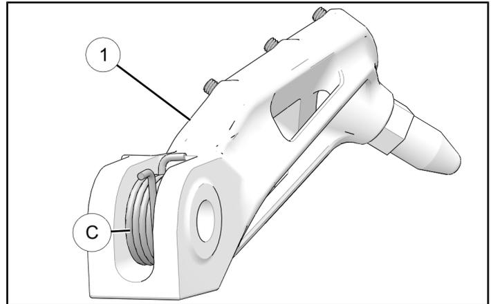
3. Coloque el reposapiés ① dentro del soporte del reposapiés e introduzca el pasador que se guardó ② a través del soporte y el reposapiés ①. Asegúrese de que el extremo del muelle ③ esté ajustado en el hueco del soporte del reposapiés.
