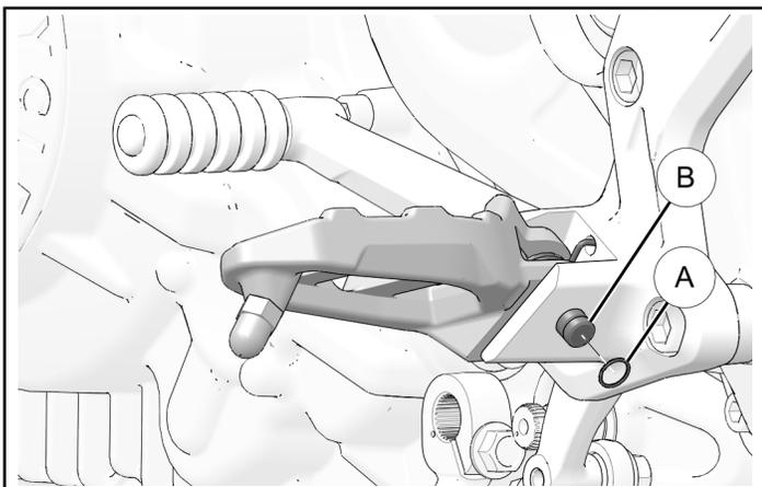
2. Retirer et conserver une goupille (B) et un ressort de repose-pieds (C) pour retirer le repose-pieds.
