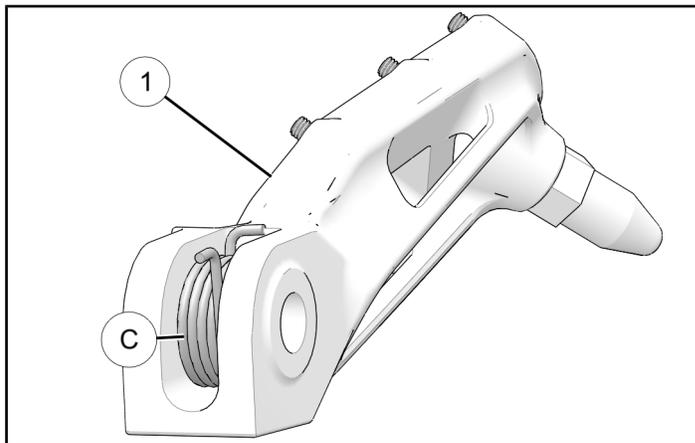
3. Placer le repose-pieds ① dans la platine repose-pieds et faire passer la goupille conservée ② dans le support et le repose-pieds ①. S'assurer que l'extrémité du ressort ③ est bien en place dans la platine repose-pieds.
