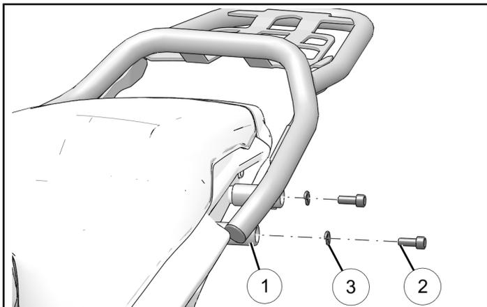
3. Die rechte Seite des Gepäckträgers mit zwei Befestigungsteilen ② und zwei Unterlegscheiben ③ befestigen.
