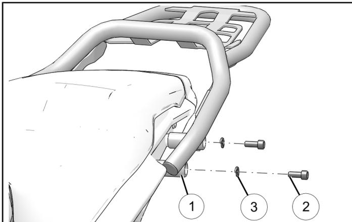
3. Instale el lado derecho del portaequipajes con los dos fijadores ② y las dos arandelas ③.
