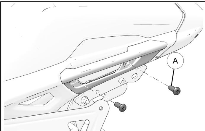
5. Linke Nummerntafel (5) auf die Schweißhalterung an der Tüllenposition montieren und am oberen Befestigungspunkt mit zwei Nummerntafel-Befestigungsteilen (9) montieren.
