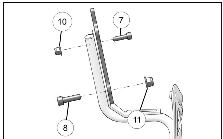
3. Zubehörhalterung mit zwei im *Zubehörfestigungssatz* Teile-Nr. 2883842 enthaltenen Befestigungsteilen für die Zubehörhalterung an den Unterrahmen montieren.
