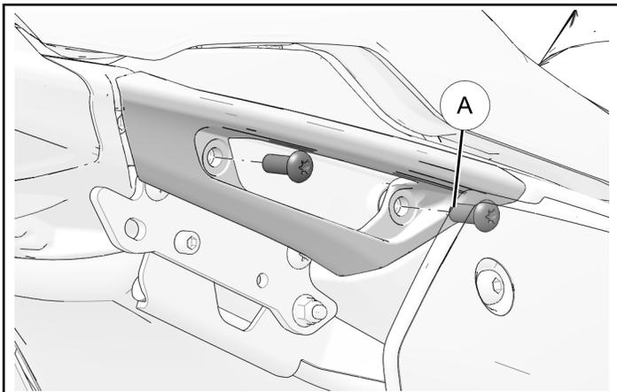
3. Rechte Nummerntafel (4) auf die Schweißhalterung an der Tüllenposition montieren und am oberen Befestigungspunkt mit zwei Nummerntafel-Befestigungsteilen (9) montieren.
