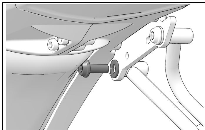
2. Rechte Nummerntafel mit einem vorderen Befestigungsteil ⑧ und einem hinteren Befestigungsteil ⑦ und Mutter ⑪ montieren.
