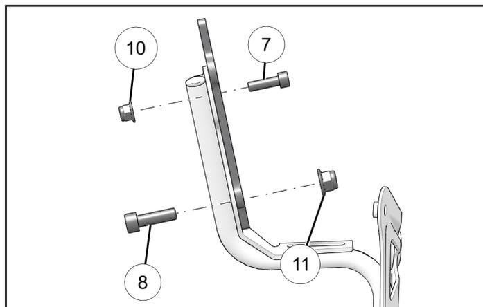
3. Installer le support de montage d'accessoires sur le sous-cadre à l'aide de deux fixations de support de montage d'accessoires, incluses dans le *kit de montage d'accessoires*, n° de pièce 2883842.
