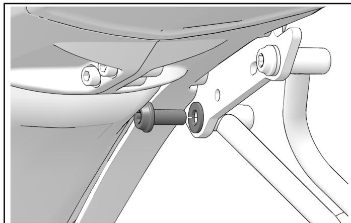
2. Installer la plaque de course de droite avec une fixation avant ⑧ et une fixation arrière ⑦ et un écrou ⑩.
