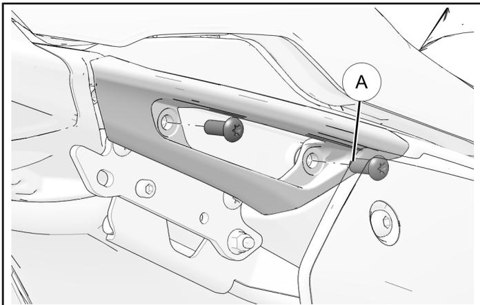
3. Installer la plaque de course de droite (4) sur le support soudé à l'emplacement de l'œillet et l'installer à l'emplacement de montage supérieur avec deux fixations de plaque de course (9).
