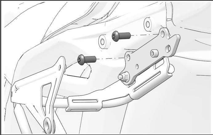
5. Installer la plaque de course de gauche ⑤ sur le support soudé à l'emplacement de l'œillet et l'installer à l'emplacement de montage supérieur avec deux fixations de plaque de course ⑨.
