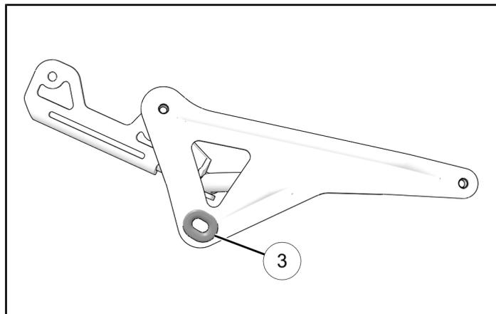
3. Installer le support de montage d'accessoires sur le support soudé avec les fixations ⑦⑧ et les écrous ⑩⑪.
