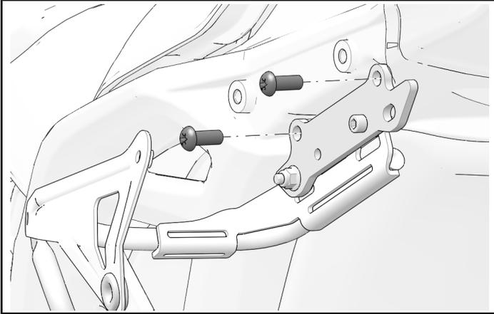
4. Installare la maniglia del passeggero con i due dispositivi di fissaggio della maniglia (A) messi da parte precedentemente.
