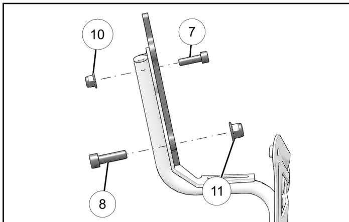
3. Installare l'attacco per accessori al sottotelaio con due appositi dispositivi di fissaggio, compresi nel *kit di montaggio degli accessori*, N° codice 2883842.
