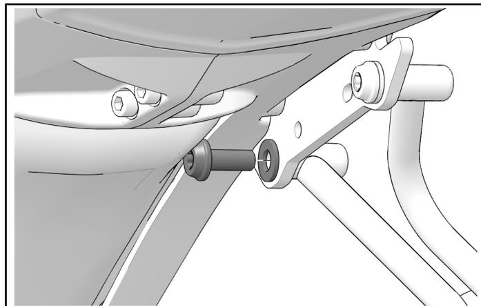
2. Installare la targa destra con un dispositivo di fissaggio anteriore ⑧ e uno posteriore ⑦ con il dado ⑪.
