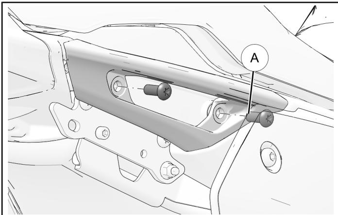
3. Installare la targa destra (4) sulla staffa saldata alla sede dell'anello di tenuta e installare sul punto di montaggio superiore con due dispositivi di fissaggio della targa (9).
