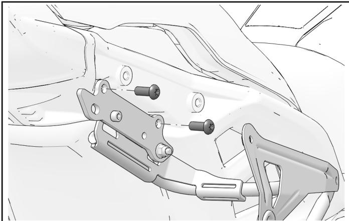
2. Installare la maniglia del passeggero con i due dispositivi di fissaggio della maniglia (A) messi da parte precedentemente.
