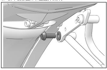
2. 用一个前紧固件⑧和一个后紧固件⑦及螺母⑪安装右侧号牌。
