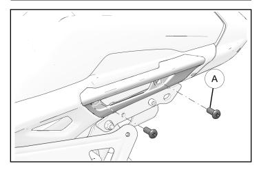
5. 在套环位置将左侧号牌⑤安装到焊接支架上,并且用两枚号牌紧固件⑨在上部安装位置安装。
