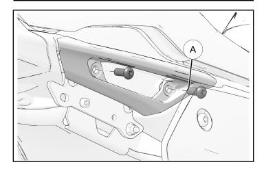
3. 在套环位置将右侧号牌④安装到焊接支架上,并且 用两个号牌紧固件⑨在上部安装位置安装。
