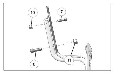
3. 用*附件固定套件*(零部件编号2883842)中的两枚 附件安装架紧固件将附件安装架安装到副车架上。
