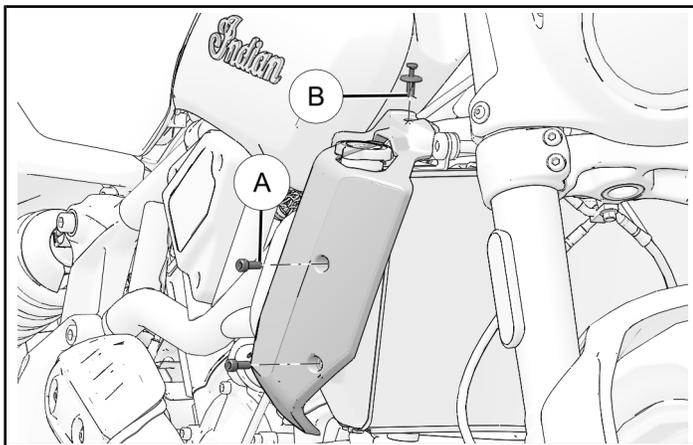
2. Quite los dos fijadores de la cubierta del radiador (A) y un pasador de presión (B) de la cubierta del radiador.
