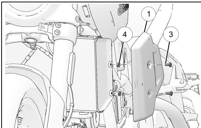
2. Installare la protezione destra **2** del radiatore con due appositi dispositivi di fissaggio **3** e due distanziali **4**.
