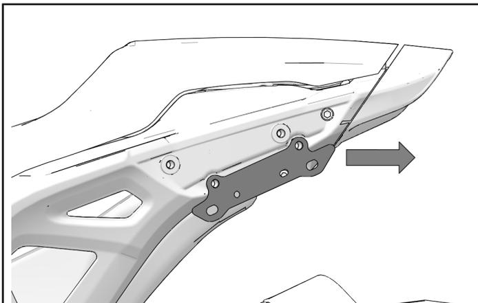
2. Zubehörhalterungsplatte (1) mit zwei Befestigungsteilen (2) einbauen.
