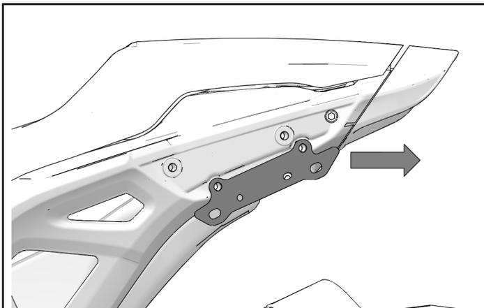
2. Instale la placa de montaje de accesorios (1) con los dos fijadores (2).
