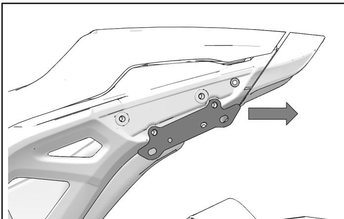
2. Installer la plaque de montage des accessoires (1) avec deux fixations (2).
