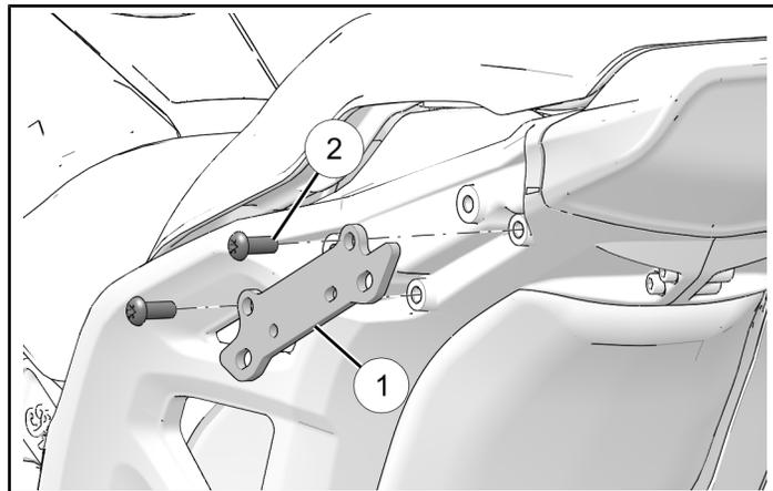
3. Réinstaller la poignée de maintien du passager avec deux fixations (A).
