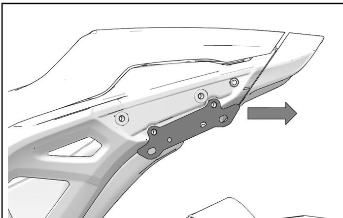
2. Installare la piastra di montaggio degli accessori **1** con due dispositivi di fissaggio **2**.
