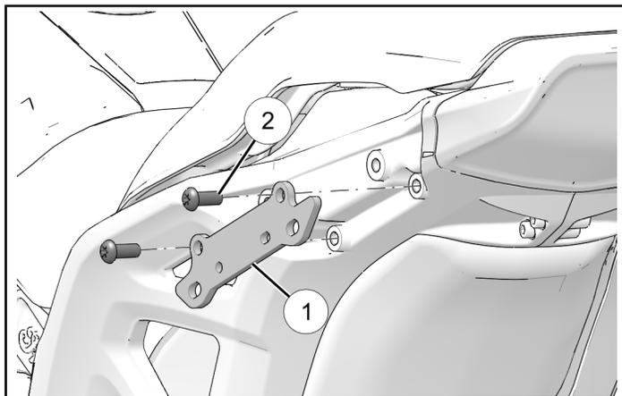
3. Reinstallare la maniglia del passeggero con due dispositivi di fissaggio **A**.
